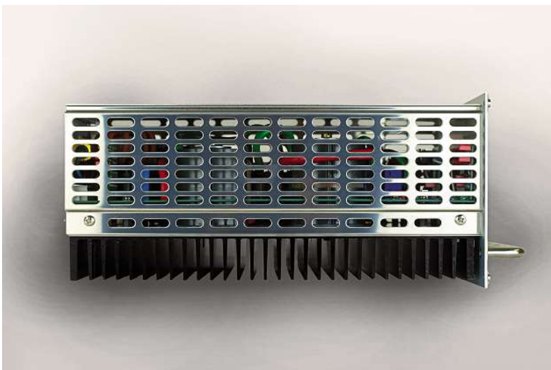
Ein Blick von oben auf den DC/DC-Wandler mit schwarzem Profilkühlkörper (unten).
